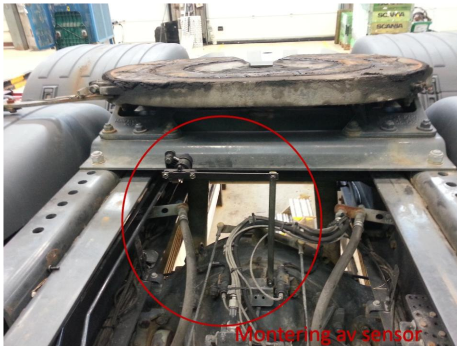
Figur 31: Vinkelsensorn monterad för att känna av nivån mellan bakaxel och chassi.
